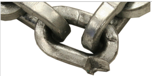
Kjettinglenken er mekanisk skadet.
